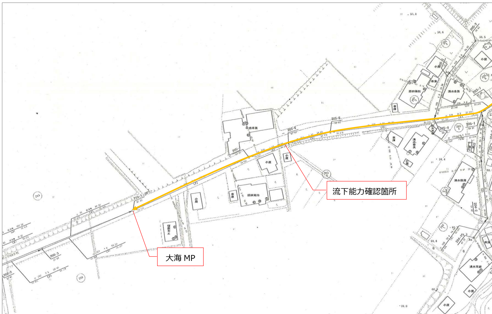
図 1.8 五反沢処理区～沖田面処理区における管渠の流下能力確認箇所（上小阿仁村特環下水道台帳図より）
