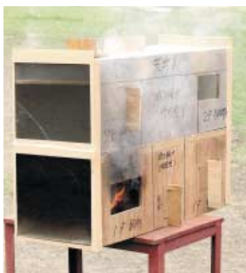
窓部分を開け閉めして煙の流れを観察
